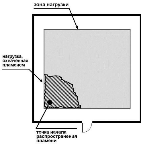
*Стадия распространения пламени при расположении места возгорания на ребре участка нагрузки*
