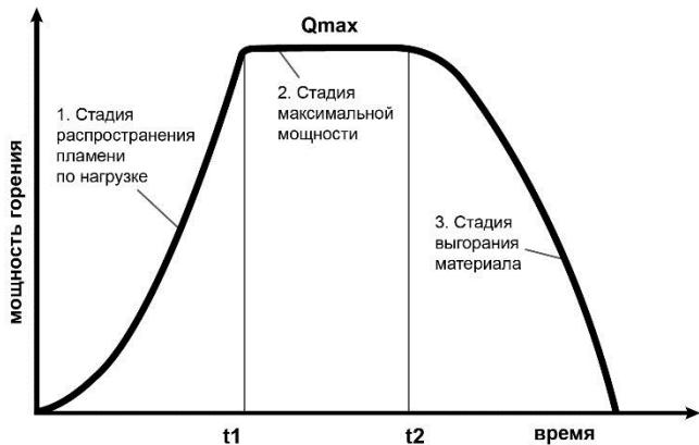
Иллюстрация стадий горения равномерно распределенной нагрузки в программе «СИТИС: ВИМ» [27], [28]:
